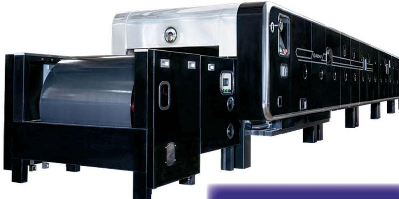
スチールベルトに直接生地を充填や、製品を乗せて焼成する仕様で天板を使用しないため焼成後の製品の取り出しから包装までを自動化しやすいのが特徴です。
